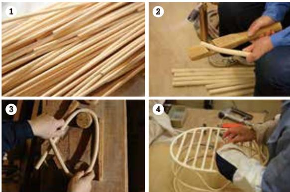
①丸籐は直径は2~3mmのものから5cmくらいまで。編む部分には、丸籐を裂いて皮の部分だけにした、皮籐を使います。②丸籐を蒸したり、熱を加え、器具を使って曲げていきます。③製品の形に合わせる木型に入れます。天然素材である籐には、元に戻ろうとする習性があったため、それも考慮しています。④工程ごとに、職人が担当します。籐にはひずみ、うねり、ねじれなどのくせがあるため、長年の熟練と勘が要求されます。
